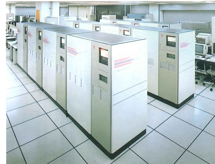
口絵2 並列推論マシン PIM/m プロセッサを2次元格子ネットワークで接続したシンプルな構成の並列推論マシン。1筐体に32プロセッサを実装し、最大構成では8筐体、256プロセッサとなる。大容量のメモリ(全体で20ギガバイト)も特徴。第I編第5章、第II編第3章参照。
