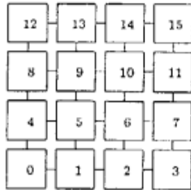
図 2: 16 台構成のマルチ PSI の論理プロセッサ配置
