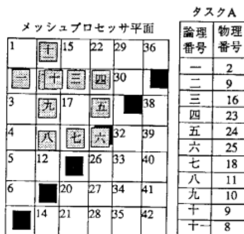
図 3: 論理プロセッサから物理プロセッサへのマッピング
