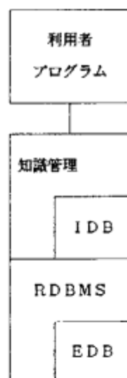
図4 ホーン・データベース・システムの構成2 階層型システム
