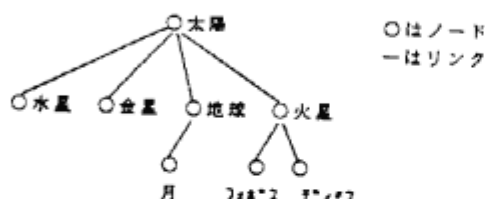
図2.5 ノードの構造例
