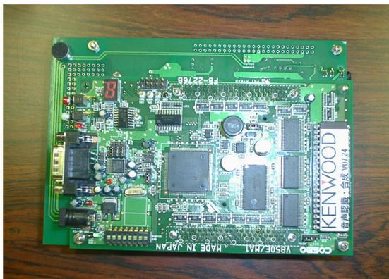
写真 1 組み込み用音声認識装置
